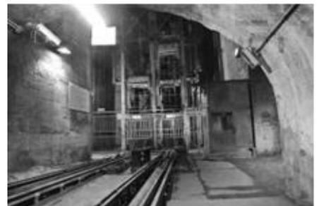
図 2. 豎坑を昇降するエレベーター状構造物のケージ。ここで、地底で採炭した石炭を地上へ搬出し、鉱員を採炭現場へ送り込んでいた。
